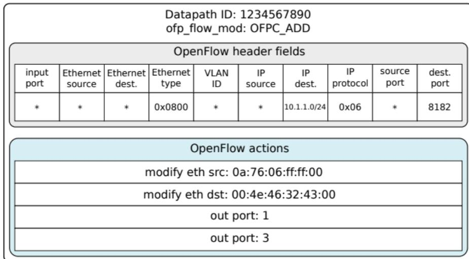
Controller generiert eine OF-Protokoll-Nachricht `ofp_flow_add` und sendet diese über den Kontrollkanal an den Switch
